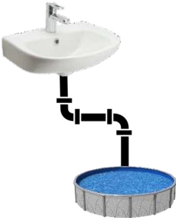
Pengumpulan limbah cair di laboratorium dibantu dengan sistem perpipaan yang menghubungkan antara muara pembuangan yang berasal dari sumber limbah dengan bak penampung sementara. Limbah cair yang telah dikumpulkan di bak penampung sementara akan dialirkan ke bak penampung utama baik secara otomatis maupun dengan pendistribusian pompa manual. Kegiatan pengumpulan mulai dari pendistribusian dan penampungan
